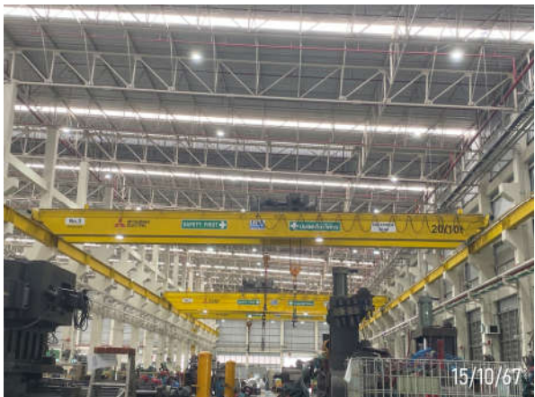
เครนภายในอาคารผลิต 2 (Overhead Crane 10/20 Ton)
